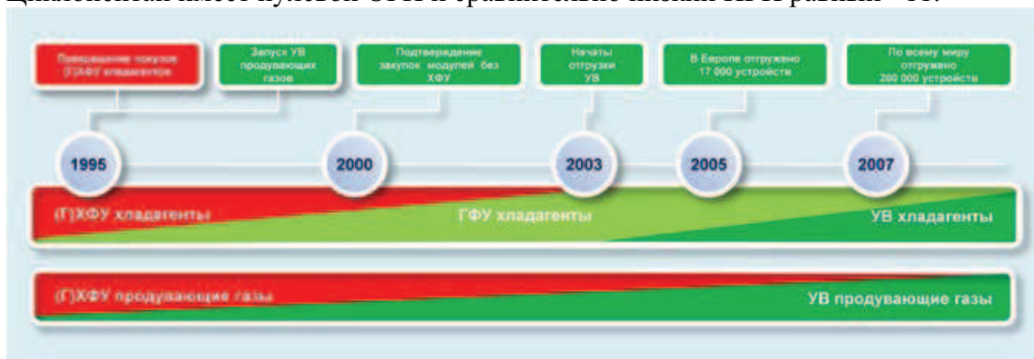
Схема 45 – Схематический обзор хладагента и продувочного газа, используемых в холодильных шкафах для мороженого компании Юнилевер
