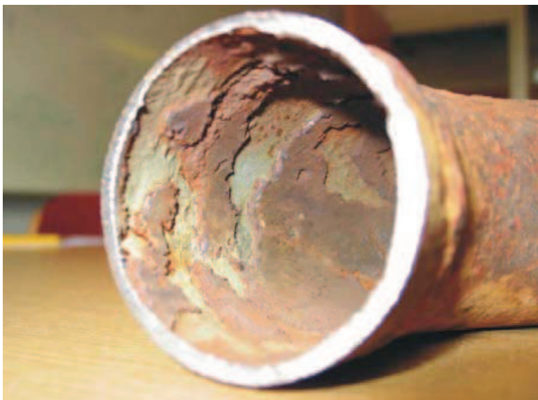
Схема 25: Коррозия трубы, вызванная угольной кислотой
