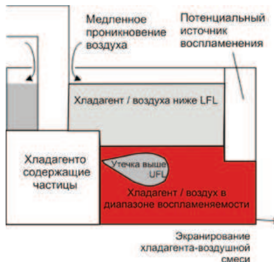
Схема 7: Иллюстрация воспламеняемой зоны после утечки хладагента внутри корпуса оборудования и постепенного выхода смеси
