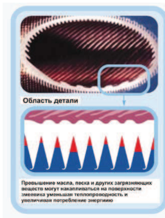
Схема 24: Частицы и осадок, засоряющие змеевики, что ведет к снижению теплообмена
