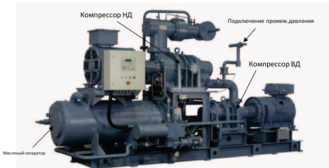
Схема 17: Блок двухфазового винтового компрессора, Грассо ГмбХ, Компрессор низкого давления НД и компрессор высокого давления ВД „последовательно“с подключением промежуточного давления, оба компрессора с плавным регулированием
