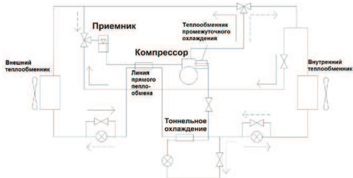
Схема 18: Принцип опытной установки КЖП, работающей на \text{CO}_2 (Сплошная линия: операция кондиционирования, Штриховая линия: работа ТН, Пунктирная линия: Двухступенчатая операция) (Якобсен и др., 2004)
